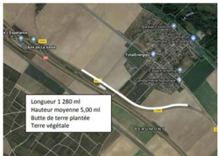
Figure 16. Implantation du merlon acoustique sur la commune de Beaumont-sur-Vesle
