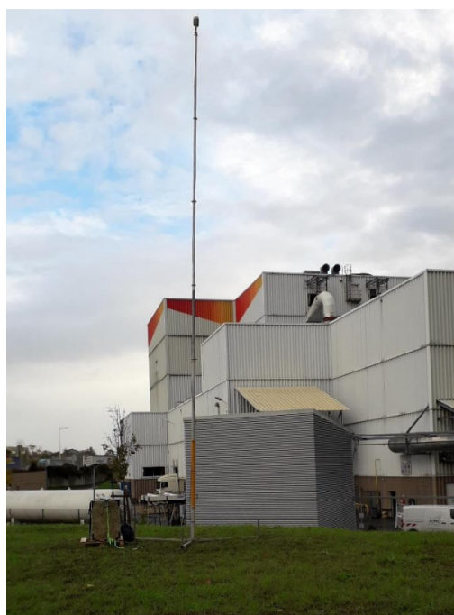
Mât équipé d'une station météorologique sur le site de REMIVAL
