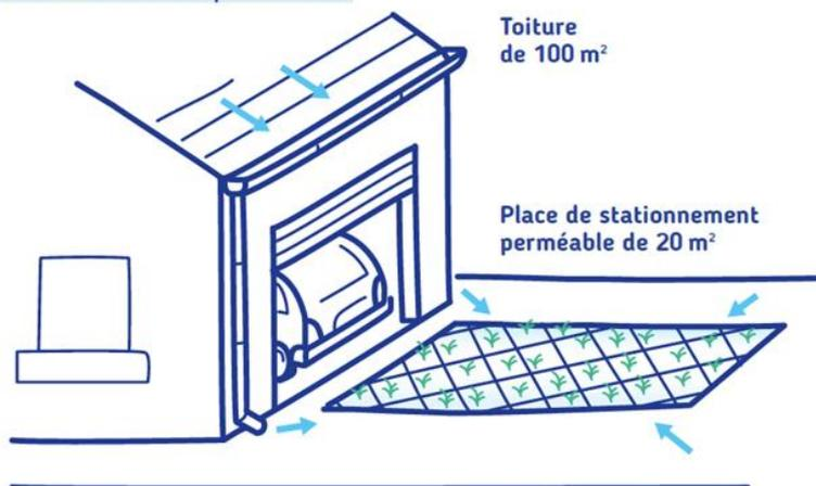
La place de stationnement perméable représente une surface de 20 m<sup>2</sup>. Elle permet d'infiltrer les eaux pluviales d'une surface de 130 m<sup>2</sup> (toiture : 100 m<sup>2</sup>, autres : 30 m<sup>2</sup>), soit un facteur de charge de 6,5 ( $FC = 130 / 20$ ).
