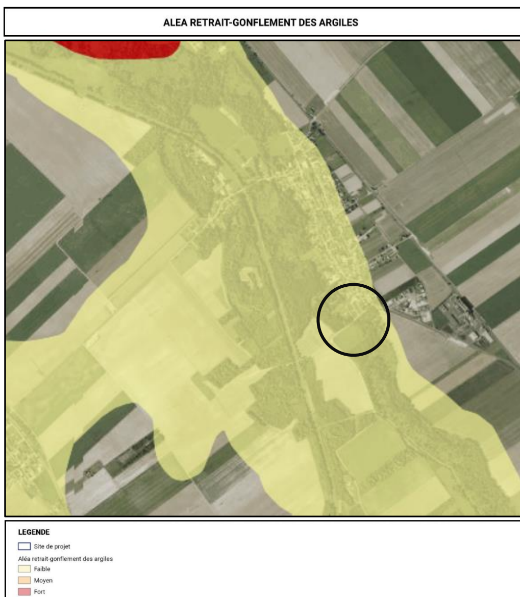
Carte du retrait-gonflement des argiles autour du site de projet
